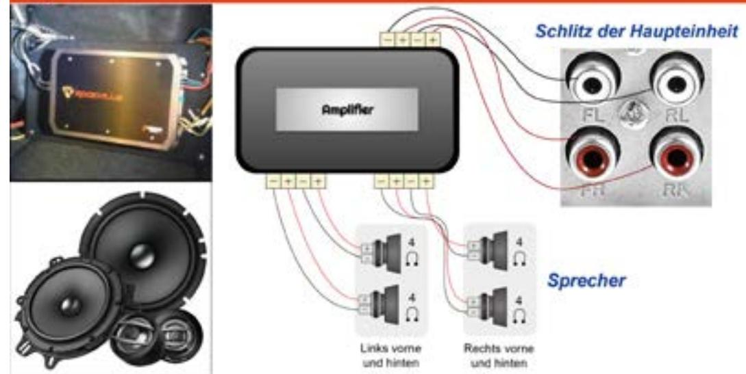
Case 3: Die 2/4-Lautsprecher mit einem Verstärker und der Subwoofer mit einem Verstärker werden separat an das Hauptgerät angeschlossen.
