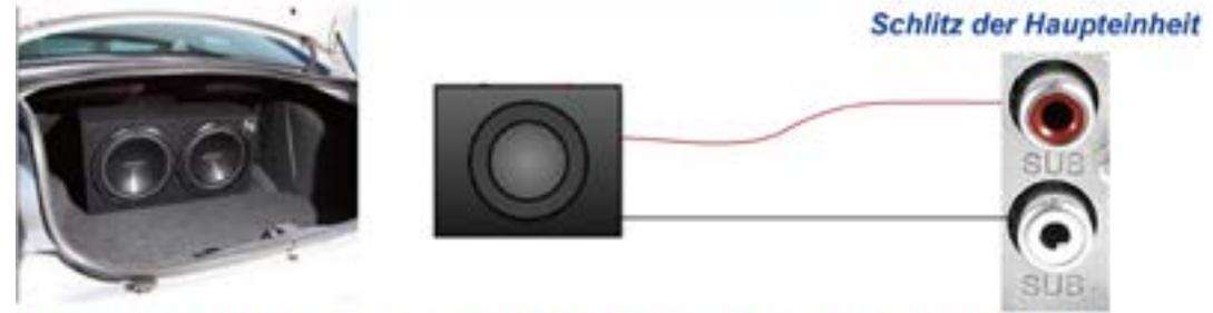
Case 2: Die 2/4-Lautsprecher mit Verstärker werden an die Haupteinheit angeschlossen.
