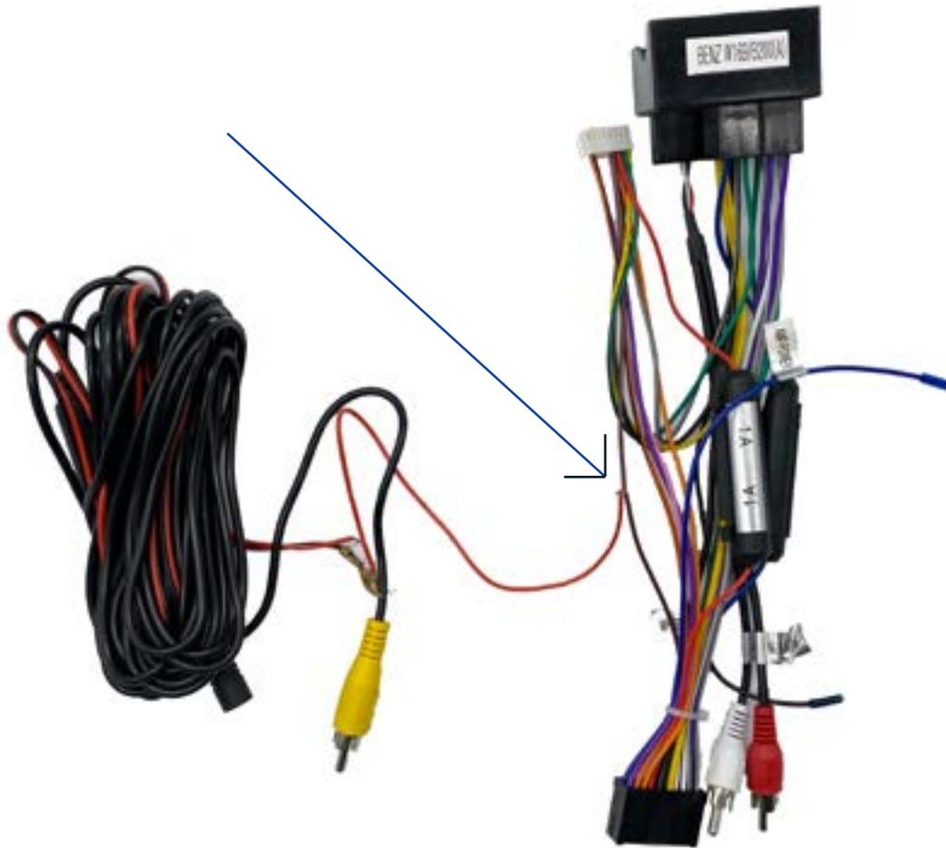
Entfernen Sie mit der Schere die Teile des **braunen Kabels**, lassen Sie den Kupferdraht frei, aber schneiden Sie das **braune Kabel** bitte nicht ab, dann verbinden Sie das Kabel der Rückfahrkamera mit dem **braunen Kabel**.
