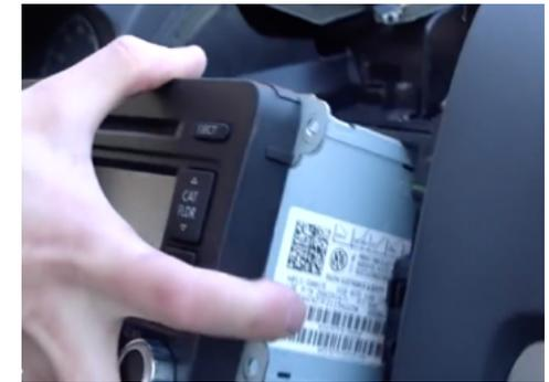
(Bemerkung : Bei einigen VW-Modellen können die oberen Schrauben unter den Lüftungsöffnungen verborgen sein, Sie müssen die Lüftungsöffnungen öffnen, um sie zu finden).
