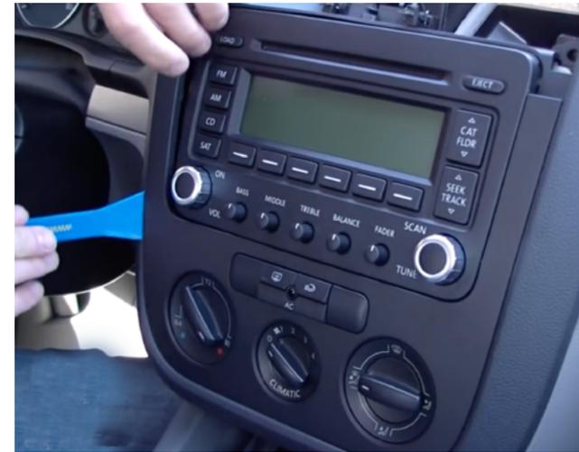
3. Danach finden Sie jede Schraube des alten Radios und schrauben sie ab. Jetzt können Sie die ganze Einheit herausziehen.
