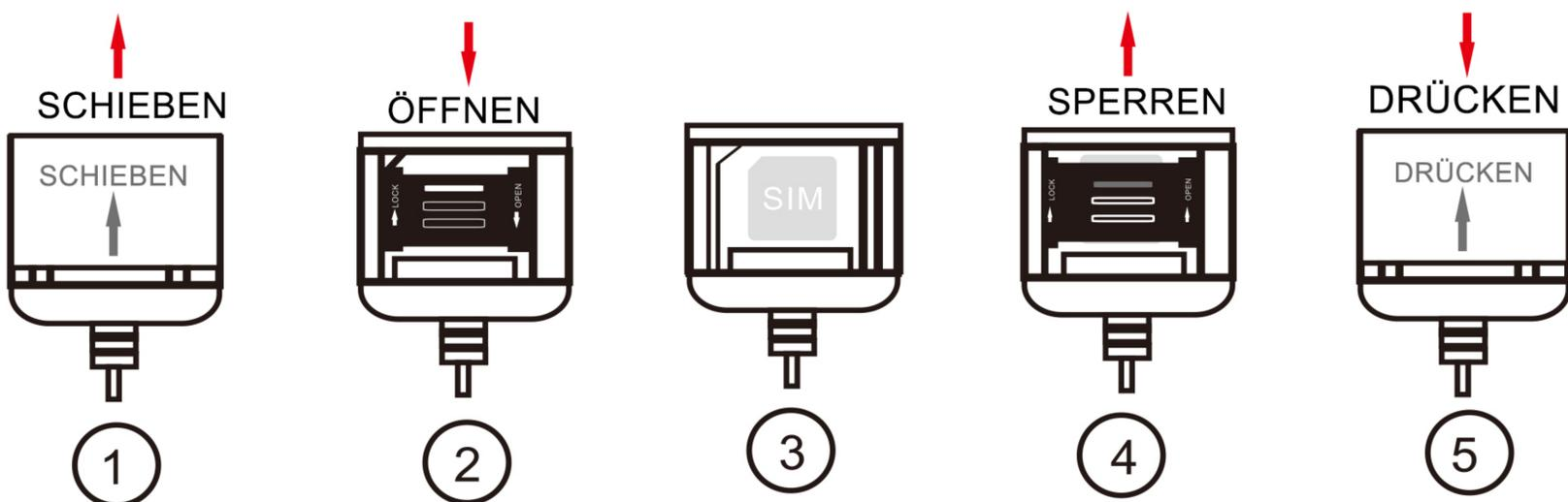
B: SIM-Kabel suchen, nach oben drücken, um Deckel zu öffnen, drücken > Clip nach unten drücken und zum Öffnen anheben, > SIM-Karte in die richtige Richtung einlegen, > Clip schließen und nach oben zum Verriegeln drücken, > Deckel schließen und zum Verriegeln drücken.
