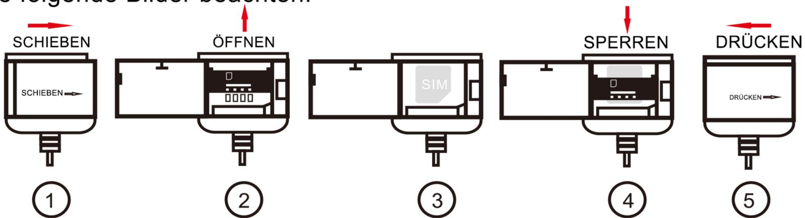
A: SIM-Kabel suchen, nach rechts drücken, um Deckel zu öffnen, > Clip nach oben zum Öffnen drücken, > SIM-Karte in die richtige Richtung einlegen, > schließen, und Clip nach unten zum Verriegeln drücken, > Deckel schließen und nach links zum Verriegeln drücken.
